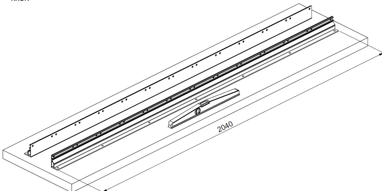
Fixer une première lame de 160mm avec les vis CHC M8x55 + écrous. Insérer une entretoise. Régler l'aplomb.
